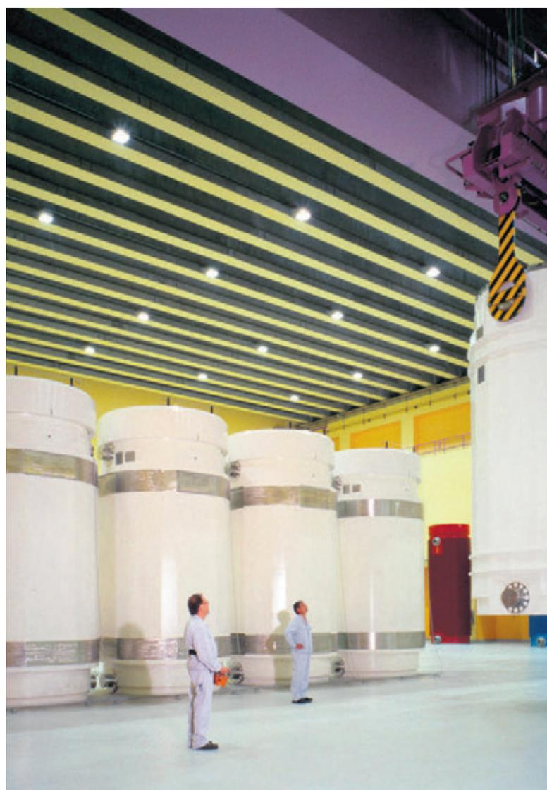
Sogenannte Castor-Behälter mit hochradioaktiven Abfällen und verbrauchten Brennelementen im zentralen Zwischenlager in Würenlingen.
