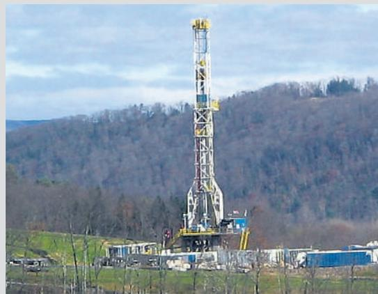
Plateforme de forage d'un puits de gaz de schiste dans le shale de Marcellus (Pennsylvanie, États-Unis)
