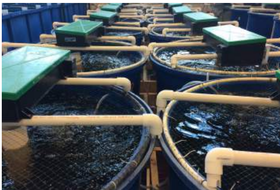
Le système de recirculation en aquaculture est une méthode d'élevage qui vise à élever des organismes en circuit fermé, où l'eau des bassins est filtrée, purifiée et réutilisée. Foto Narek75 - Own work, CC BY-SA 4.0
